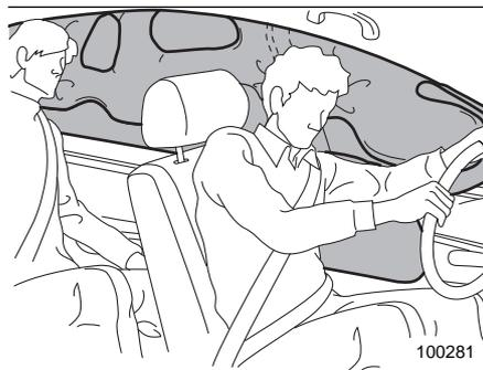
Боковые подушки безопасности водителя и пассажира переднего сиденья и подушки-шторки безопасности имеют отдельные датчики удара, поэтому они срабатывают независимо друг от друга. В связи с этим при аварии они могут сработать не вместе. Кроме того, срабатывание боковых подушек безопасности и подушек-шторок безопасности происходит независимо от срабатывания фронтальных подушек безопасности водителя и пассажира переднего сиденья, расположенных в рулевом колесе и в панели приборов автомобиля.
